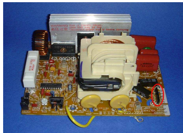
Inversor de horno microondas en el círculo rojo la resistencia bleeder
